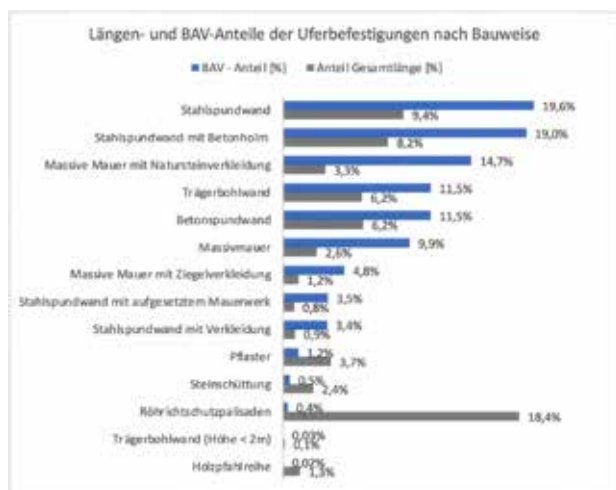
Abb. 5.: Verteilung der Längen- und BAV-Anteile nach Bauweise (ohne unbefestigte Ufer) nach Ortmann
