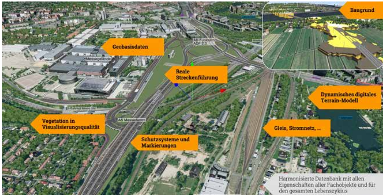
Abb. 1: Vernetztes Gesamtmodell, das dynamisch alle Fachplanungen parametrisch integriert
