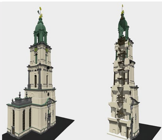
Virtuelle Rekonstruktion mit Materialkennzeichnung (Ziegelmauerwerk, Sandstein, Holz, Kupferblech), Architekturbüro Bernd Redlich 2011
